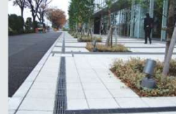
HỆ THỐNG MƯƠNG GUTTER SYSTEM
